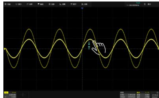
通过垂直方向的两点缩放手势控制波形的垂直档位。当多个通道打开时，控制的是波形离触摸区域最近的通道
